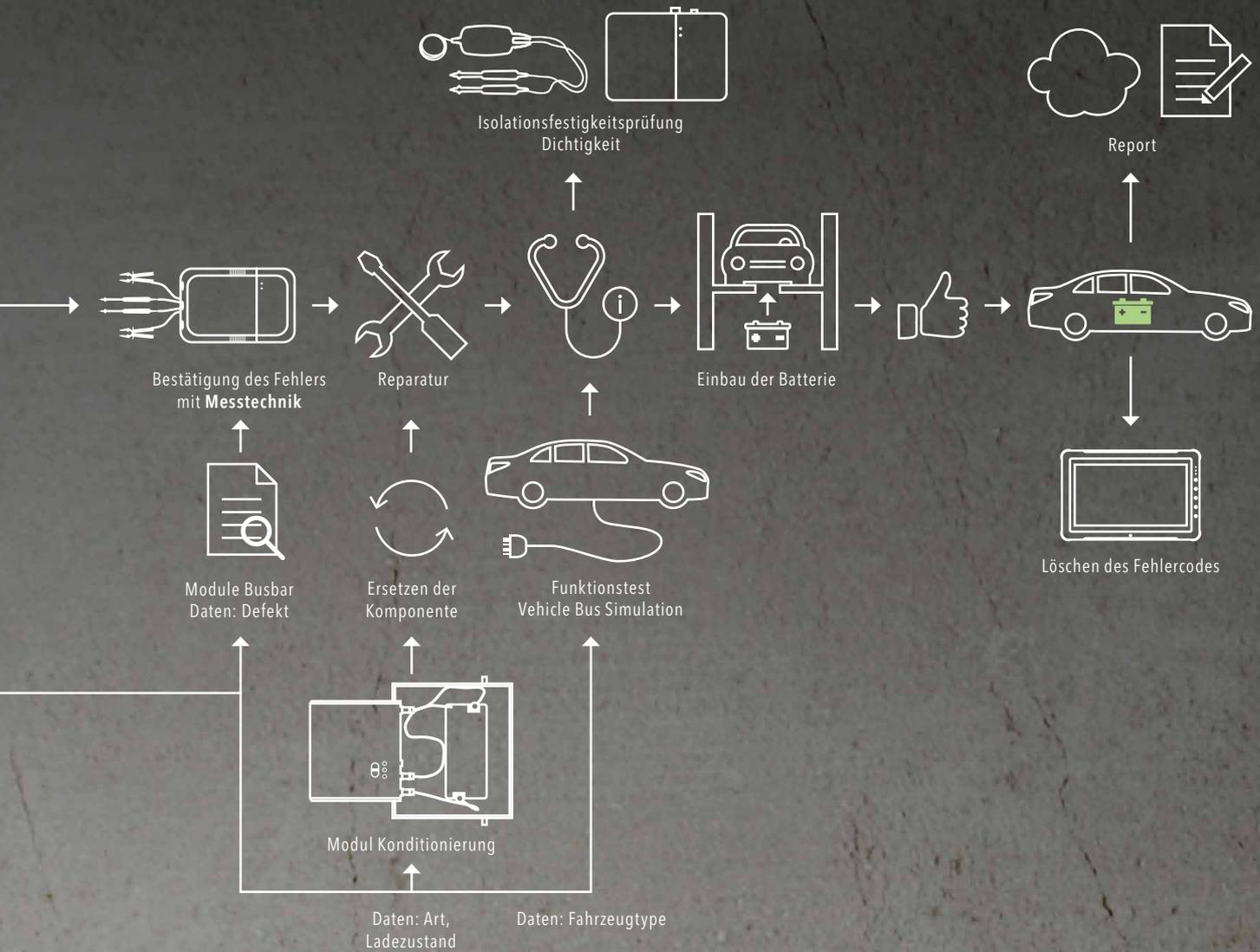
Der elektrische Hochvolt-Antriebsstrang zusammen mit den elektrischen Nebenaggregaten stellt ein komplexes System von mechanischen, elektrischen, elektrochemischen und elektronischen Komponenten dar. Viele Teile unterliegen Verschleiß und Alterung. Entsprechend vielfältig sind die Fehlermöglichkeiten. Aktuell wird hauptsächlich die Batterie repariert, andere HV-Komponenten werden typischerweise getauscht.
