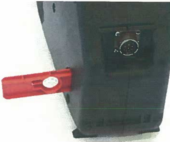
Abbildung 3: Schnittstelle und Filterhalterung am "DiSmoke 480"
