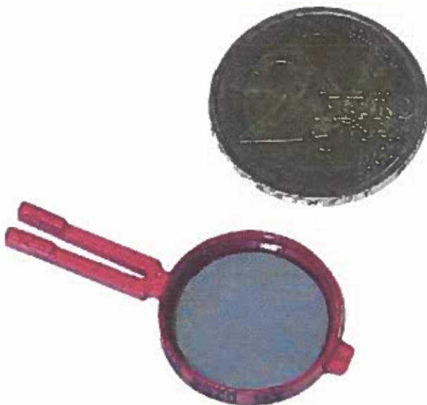
Abbildung 4: Transmissionsfilter (zum Größenvergleich 2 € Münze)
